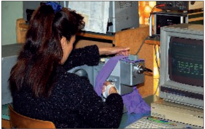
Abb. 2: Bevor die Garne zum Kunden gehen, wird jedes Garn gestrickt und entsprechend den Anforderungen im Labor gefärbt. Geliefert wird erst dann, wenn die Garne geprüft und freigegeben wurden. Immer mehr Kunden nehmen diesen Service in Anspruch.
