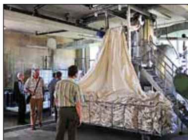
Abb. 2: Die über 12 Meter breiten Stoffe werden in dieser Maschine ausgerüstet.
