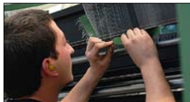
Eschler AG, Einziehen des Riet an der Wirkmaschine
