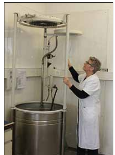
Beregnungsprüfung nach Bundesmann
