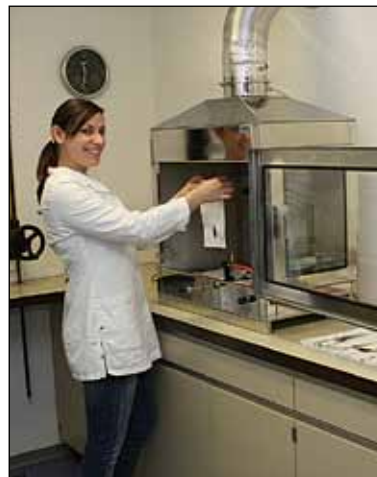
Brennkasten für DIN 4102 B2
